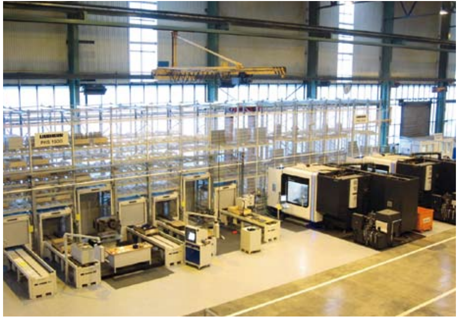
Palettenhandhabungssystem PHS1500 in Nenzing, geliefert von der Liebherr Verzahrtechnik GmbH Kempten, das zwei Bearbeitungszentren von Deckel Maho bestückt.
